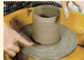
4. 用割线切下坯体，取坯。在坯体半干时进行修坯。
