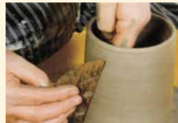
3. 拉薄坯体，然后用型板修正坯体。
